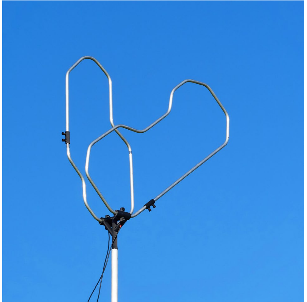
outil antenne artisanal pour débusquer les fantômes tiges et tubes d'aluminium, impression 3D, clé USB SDR, Raspberry Pi
